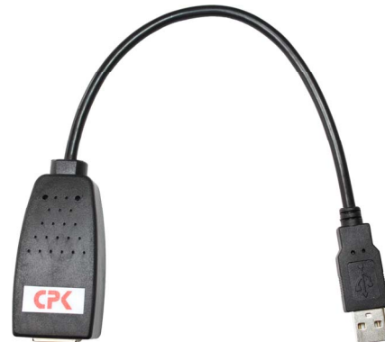
Abb 6.: Analyser für externe Ansteuerung und Übertragung von Daten auf einen Computer
